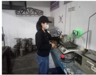
Gambar 2. Pengujian Gradasi Limbah Batu Marmer
