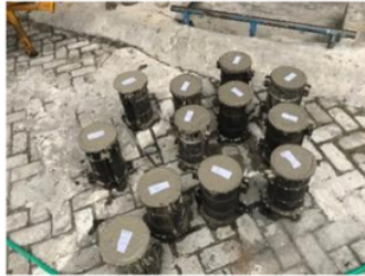
Gambar 4. Pembuatan Benda Uji Sumber: Dokumentasi, 2024
