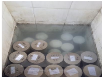
Gambar 5. Proses Perendaman Benda Uji Sumber: Dokumentasi, 2024
