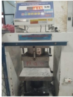
3 Gambar 5. Hasil uji kuat tekan paling tinggi usia 14 hari
