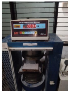
Gambar 2. Hasil uji kuat tekan paling tinggi umur 7 hari
