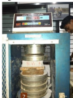
Gambar 3. Hasil uji kuat tekan paling rendah umur 7 hari
