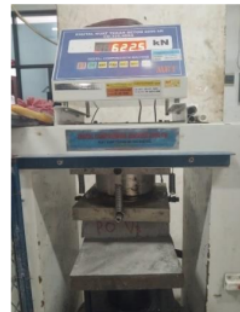
Gambar 4. Hasil uji kuat tekan paling tinggi usia 14 hari
