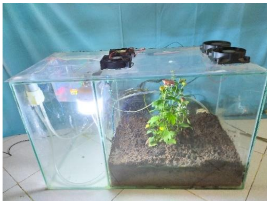
Gambar 8. Purwarupa Alat Telemonitoring Rumah Kaca Tanaman Krisan
